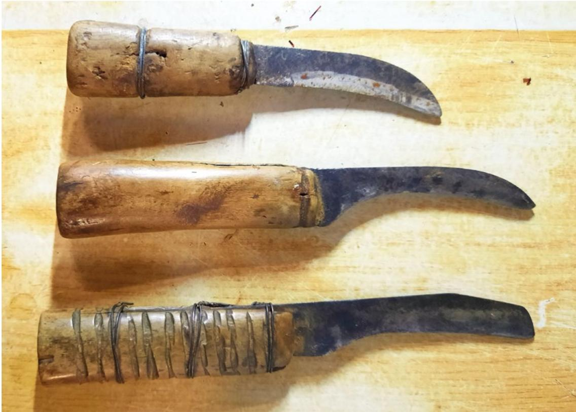
Couteaux à greffer (IM83000092, Les Mayons) fabriqués dans les années 50/60, composés d'un manche en châtaignier et d'une lame des anciennes machines à rabot de bouchonnier.
