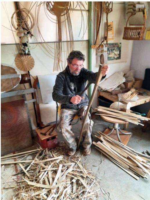
Après avoir sélectionné les éclisses propres à être utilisées, le vannier commence par les fendre par le milieu, à l'aide d'un fendoir.
