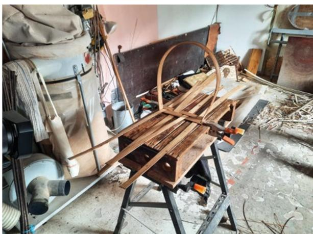
Des éclisses suffisamment longues sont positionnées sur le fond du panier, toujours en nombres pairs, en laissant des intervalles pour les lattes de la largeur.
