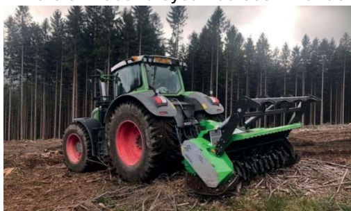
Photos 5 et 6 : Broyeur à marteaux fixes sur tracteur forestier
